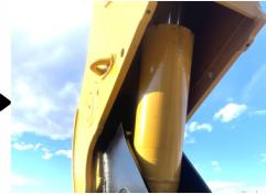
分解組立時に役立つシリンダセッティング棒。可動アームが開いた位置で支持しますので、分解時にはピンを抜いてもシリンダが落ちず、組立時にはアームとの穴位置合わせがスムーズです。(特許出願済み)
