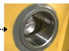
機内ホースは本体奥にコンパクトに収まり、更にはシリンダーの後ろに隠れる配置になっています。作業中に鉄筋がホースに当たって損傷するリスクが大幅に減少します。
