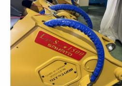
機外ホースの収納穴を新設しました。ホース長さの半分ほどが内部に収納されるのでバタつきません。揚重、横倒し、運搬等の安全性と美化意識を向上させる小さなこだわりです。(特許取得済み)
